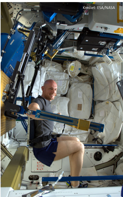
↑ ESA-astronaut Alexander Gerst gebruikt het Advanced Resistive Exercise Device (ARED) van het internationale ruimtestation om fit te blijven door gewichtheffen te simuleren met luchtdruk in plaats van met traditionele gewichten.
