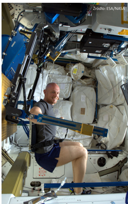
↑ Astronauta ESA Alexander Gerst korzysta ze specjalnego urządzenia do ćwiczeń siłowych (ARED) na Międzynarodowej Stacji Kosmicznej, aby zachować formę, symulując podnoszenie ciężarów przy użyciu ciśnienia powietrza zamiast tradycyjnych ciężarów.
