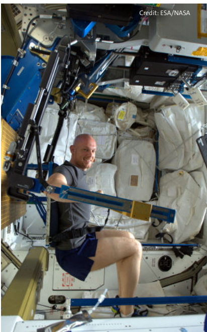
↑ ESA-astronaut Alexander Gerst nutzt das Advanced Resistive Exercise Device (ARED) der ISS, um sich fit zu halten, indem er Gewicht-heben mit Luftdruck anstelle von herkömm-lichen Gewichten simuliert.
