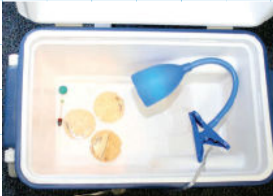
Joonis 1. Soojaruumi näidis A, tugevate seintega kast
