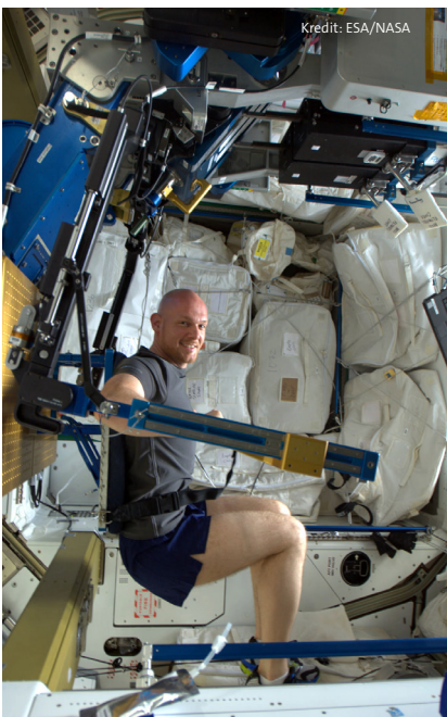
↑ ESA-astronaut Alexander Gerst bruger Den Internationale Rumstations Advanced Resistive Exercise Device (ARED) til at holde sig i form. Maskinen simulerer vægtløftning ved hjælp af lufttryk i stedet for traditionelle vægte.
