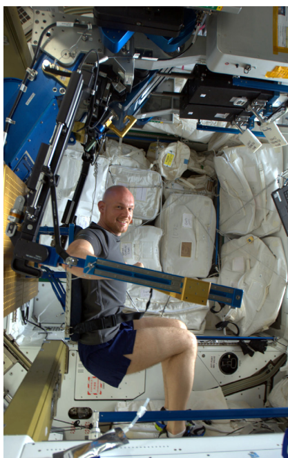
↑ ESAのアレクサンダー-ゲルスト宇宙飛行士（ドイツ）は、国際宇宙ステーションの高度抵抗運動装置（ARED）を使って、従来の重りの代わりに空気圧を利用した重量挙げのシミュレーションを行い、健康維持に努めている。
