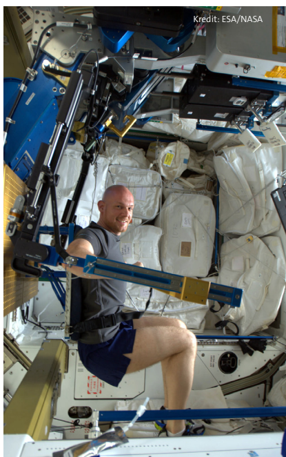
↑ ESA-astronauten Alexander Gerst använder den internationella rymdstationens ARED (Advanced Resistive Exercise Device) för att hålla sig i form genom att simulera tyngdlyftning med lufttryck istället för traditionella vikter.
