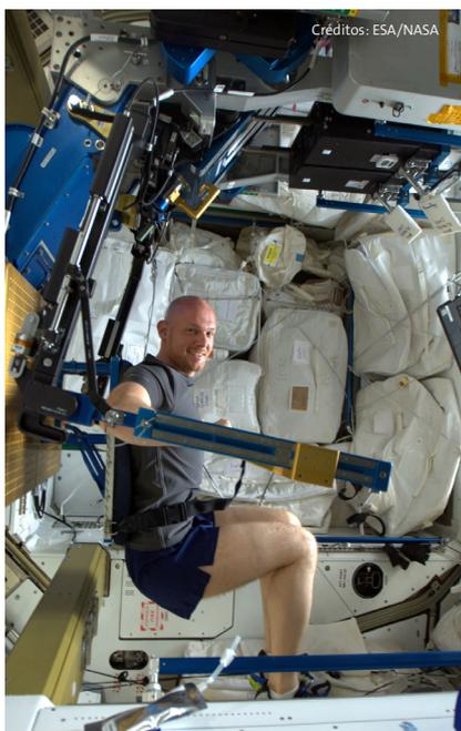
↑ O Astronauta da ESA Alexander Gerst utiliza o dispositivo avançado resistivo (ARED) da ISS, que simula o levantamento de pesos usando a pressão do ar em vez dos pesos tradicionais para se manter em forma.
